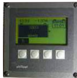
Kuva 2.23. Akunvalvontamittari mahdollistaa akkujen toiminnan monipuolisen seuraamisen.
