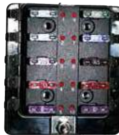
Kuva 5.22. Tyypillinen pienen veneen kymmenellä lattasulakkeella varustettu sulakerasia.
