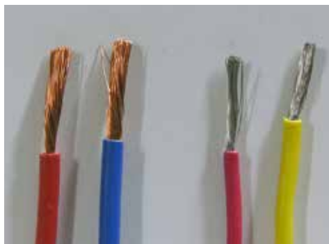
Kuva 2.34. Veneessä tulee käyttää esitinattuja johtoja (oikealla) ja välttää paljaiden johtimien (vasemmalla) käyttöä.
