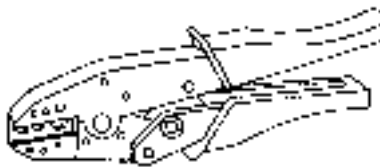
Kuva 5.15. Kalliimmilla erikoispihdeillä syntyy aina samanlainen puristusliitos, eivätkä pihtien leuat riko eristettä.
