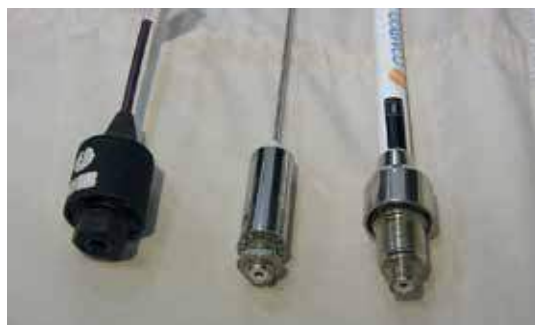
Kuva 2.35. Vasemmalla oleva antenni on ns. eristetty antenni, muut eristämättömiä.
