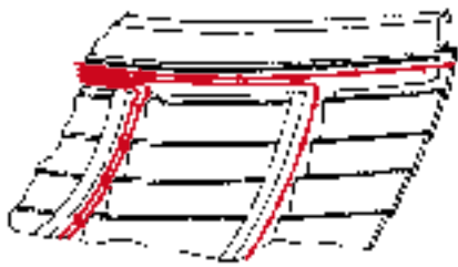
Kuva 5.7. Siististi kiinnikkeillä toteutettu johdotus veneen laidalla.
